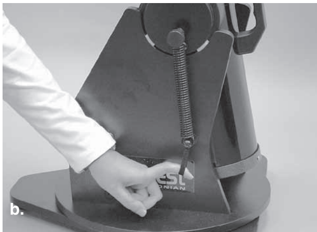
Figura 7: (a) Para acoplar el resorte a la base, agarre el lazo de extracción con el dedo índice y tire hasta el resorte. (b) Mientras tira hacia abajo, deslice el anillo del extremo del resorte sobre la cabeza del tornillo y en la parte estrecha del separador de nylon. A continuación, suelte el lazo de extracción.
