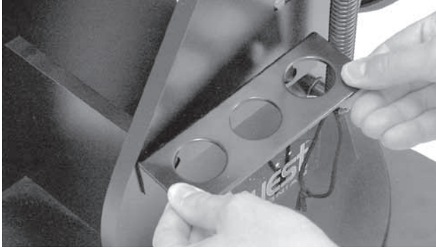
Figura 4. Usando los dos tornillos suministrados, instale el portaoculares de aluminio en los agujeros pretaladrados que hay a mitad de camino hacia abajo en el panel del lado izquierdo de la base.
