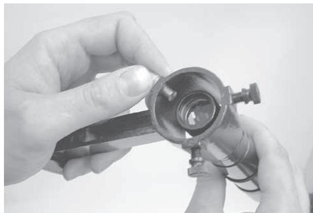
**Figure 8b :** Insertion du chercheur dans son support
