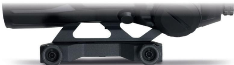
Nachdem die Optik an der gewünschten Stelle optimal ausgerichtet worden ist, müssen nur noch die Muttern wieder mit 3,5 Nm fixiert werden. Zur weitergehenden Anpassung an die individuellen Bedürfnisse lässt sich die Höhe der optischen Achse über Distanzstücke variieren. Durch den Einsatz der beiliegenden Distanzstücke (3 mm oder 5 mm) lässt sich diese so auf 42 mm respektive 44 mm erhöhen.
