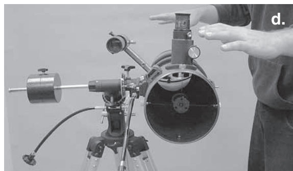
Abbildung 4. Um eine ordnungsgemäße Funktion der parallaktischen Montierung zu gewährleisten, muss das Optikrohr des Teleskops sowohl auf der RA- als auch der Dek-Achse optimal ausbalanciert sein. (a) Lockern Sie die RA-Arretierschraube, und schieben Sie das Gegengewicht so an der Gegengewichtsstange entlang, dass ein perfektes Gleichgewicht mit dem Optikrohr herrscht. (b) Wenn Sie die Hände nun vom Teleskop nehmen, sollte sich das Optikrohr von selbst nicht mehr nach oben oder unten bewegen. (c) Lockern Sie die Dek-Arretierschraube und die Rändelschrauben der Rohrschellen um einige Umdrehungen, und schieben Sie das Teleskop in den Rohrschellen je nach Bedarf vor oder zurück. (d) Wenn das Optikrohr auf der Dek-Achse optimal ausbalanciert ist, wird es seine Position auch dann beibehalten, wenn Sie die Hände vom Teleskop nehmen.
