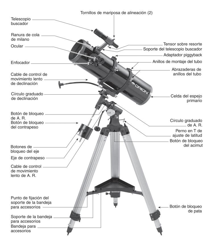
Figura 1. Diagrama de piezas del SpaceProbe 130ST
