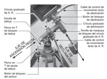
Figura 2. Montura ecuatorial del SpaceProbe 130 ST.
