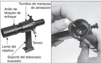
**Figura 3a.** Telescopio buscador de 6x30.
