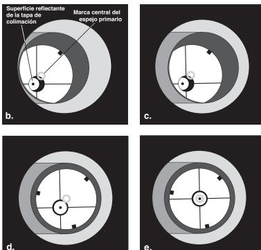
el espejo primario sea visible. (d) El espejo secundario está correctamente alineado, pero todavía es necesario ajustar el espejo primario. Cuando el espejo primario está correctamente alineado, el "punto" se centra, como en (e).
