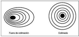
**Figura 12.** Una prueba de estrella determinará si la óptica de un telescopio está correctamente colimada. Una visión desenfocada de una estrella brillante a través del ocular debería aparecer como se muestra a la derecha si la óptica está perfectamente colimada. Si el círculo es asimétrico, como en la ilustración de la izquierda, el telescopio necesita colimación.
