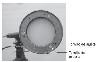
**Figura 11.** Extremo posterior del tubo óptico (parte inferior de la celda del espejo primario). Los tres pares de tornillos de ajuste y tornillos de estrella ajustan la inclinación del espejo primario.
