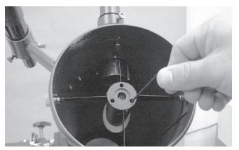
**Figura 10.** Ajuste la inclinación del espejo secundario, aflojando o apretando los tres tornillos de ajuste de alineación con una llave Allen de 2 mm.
