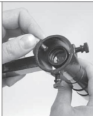
**Figure 3b.** Insertion du chercheur dans son support
