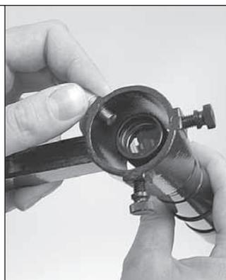
**Figura 3b.** Inserimento del cercatore nel relativo supporto
