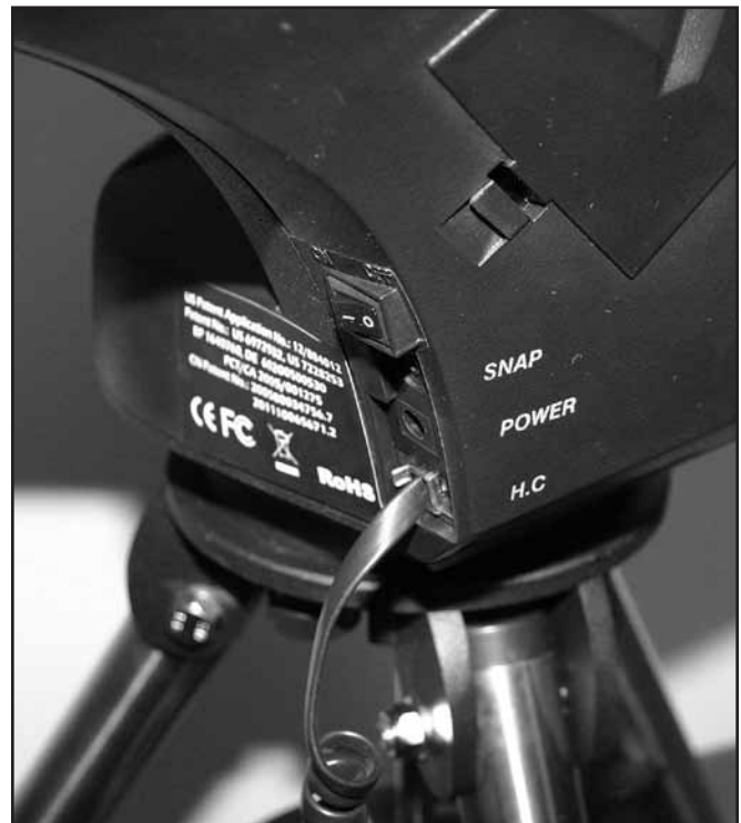
Figura 16 Los puertos electrónicos del controlador de mano y una batería de 12 VCC opcional se encuentran en la base del brazo de la montura. El puerto SNAP permite el control de una cámara réflex digital cuando se utiliza con el cable adecuado.
