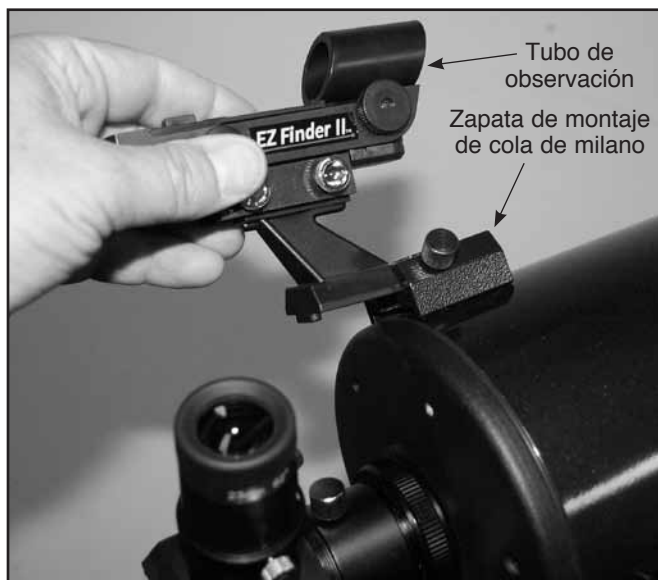
Figura 12. Inserte la EZ Finder II en su base de cola de milano en la orientación mostrada y sujétela con el tornillo de mariposa.
