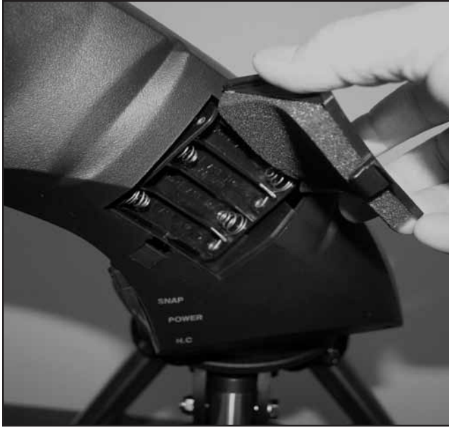
Figura 15. La montura StarSeeker IV se alimenta con ocho pilas AA suministradas por el usuario, que se instalan en el brazo de la montura.
