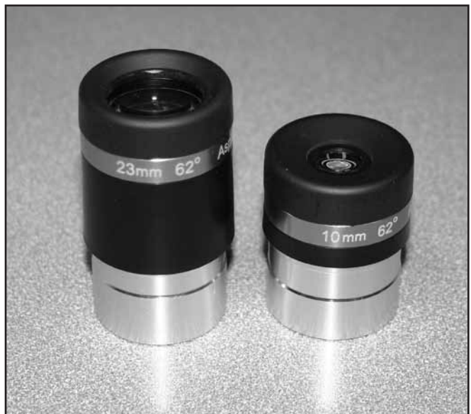
Figura 14. Los telescopios StarSeeker IV incluyen oculares de campo ancho de 23 mm y 10 mm.
