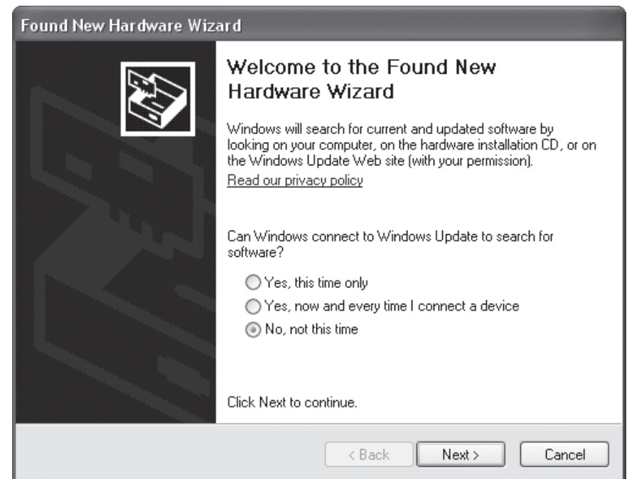
Abbildung 6. Unter Windows XP wird der Assistent „Neue Hardware gefunden“ geöffnet, wenn Sie den SSAG-Autoguiden das erste Mal an den USB-Anschluss anschließen.
