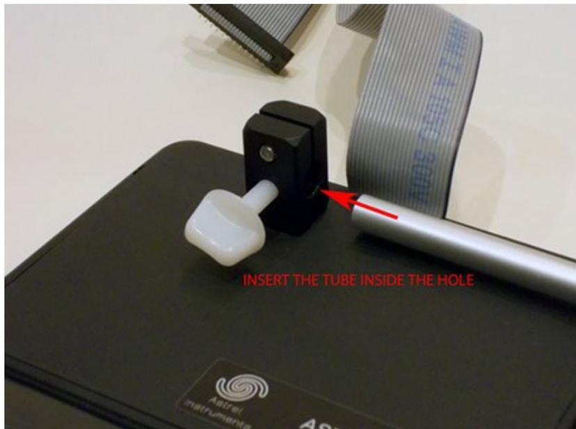
INSERT THE TUBE INSIDE THE HOLE
