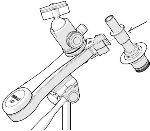
**4.9.** Para alinear la montura con la Estrella Polar con más precisión, deslice el manguito de plástico sobre el buscador e insértelo en el soporte con un clic.
