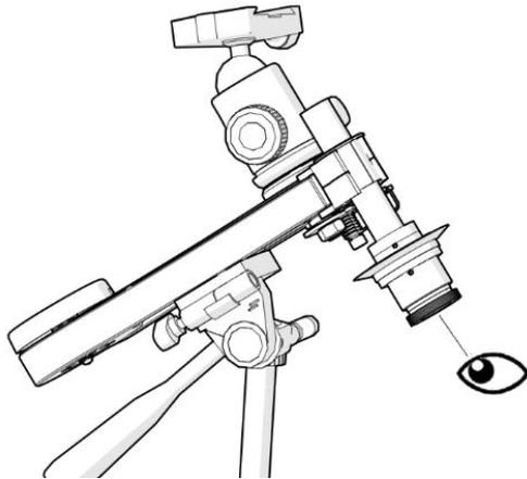
**4.10.** Eche un vistazo a través del buscador de la Polar (A) y centre la Estrella Polar en el campo visual. Gire las palancas de ajuste de precisión del trípode para hacerlo. Lea la siguiente sección para obtener más detalles sobre cómo emplear correctamente la MiniTrack LX y la importancia de un equilibrado correcto.
