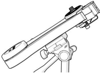
**4.3.** Asegúrese de que la MiniTrack quede paralela a la base del adaptador. Esto es importante, ya que la inclinación se debe reajustar de forma precisa para colocar la montura en estación.
