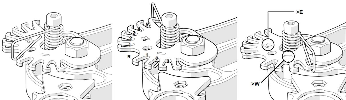
**Evite una tensión innecesaria del resorte, ya que podría alterar la velocidad de seguimiento del reloj del temporizador.**
