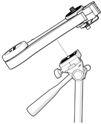
**4.2.** La MiniTrack es compatible con cualquier placa de trípode  $\frac{1}{4}$ " (n.º 9, lado B). Coloque la MiniTrack en la placa del trípode (no se suministra) de la forma mostrada. Asegúrese de que la MiniTrack quede de forma que se pueda ajustar la inclinación.
