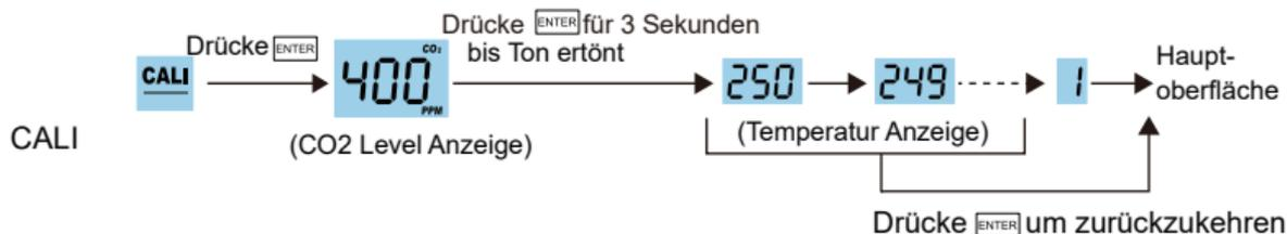
Platzieren Sie das Gerät vor Kalibrierung mindestens 20 Minuten bei geöffneten Fenstern oder Draussen um eine Atmosphäre mit 400ppm CO<sub>2</sub> zu erreichen. Warten Sie, bis der CO<sub>2</sub>-Messwert stabil ist und befolgen Sie anschliessend die obigen Schritte zur Kalibrierung. Nach Kalibrierung 10 Minuten vor dem normalen Gebrauch stehen lassen.
