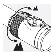
Drej indstillingsringen til forstørrelse helt op til 180° for at opnå den ønskede forstørrelse. Indstillingen foretages løbende. Skalaen på indstillingsringen gør det nemt at aflæse indstillingen. Det bløde, riflede overtræk på indstillingsringen har et lille fremspring for at lette orienteringen. Afhængig af modellen har indstillingsringen til forstørrelse også en hage ved 1 x forstørrelse (CLICKONE), som gør dig opmærksom på, at du går ind i VIEWPLUS-området.
