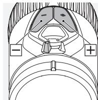
быстрого получения идеального уровня яркости можно нажать и удерживать одну из кнопок (длинный импульс). Для выполнения точной настройки используйте однократное нажатие кнопок (одиночный импульс).
