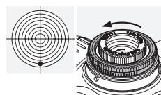
Поверните внешнее рифленое кольцо на верхней турели в направлении H (против часовой стрелки).
