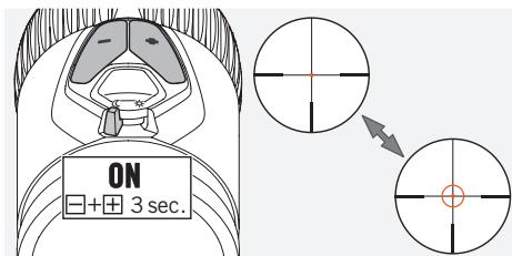
Drej kontakten FRA/DAG/NAT til positionen DAG eller NAT for at tænde for den oplyste ring på FLEXCHANGE 4A-IF sigtet. Sigtebelysningen er nu aktiveret. Tryk på knapperne +/- samtidigt i tre sekunder for at tænde for den oplyste ring. Gentag dette trin for at slukke for ringen igen.
