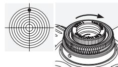
Vrid den yttre räflade ringen på topptornet i motsatt riktning mot H (dvs. med-sols).
