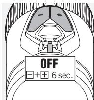
Puede desactivar la función SWAROLIGHT llevando el interruptor DESACTIVADO/DÍA/NOCHE a la posición central y pulsando los botones +/- simultáneamente durante 6 segundos. La luz parpadeará dos veces para confirmar que se desactiva la función. Puede volver a activar SWAROLIGHT repitiendo este paso.
