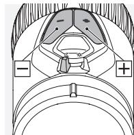
saavuttaa nopeasti painamalla ja pitämällä yhtä painiketta painettuna (pitkä pulssi). Tarkkoja säätöjä tehdään painamalla jompaakumpaa painiketta kerran (yksittäinen pulssi).
