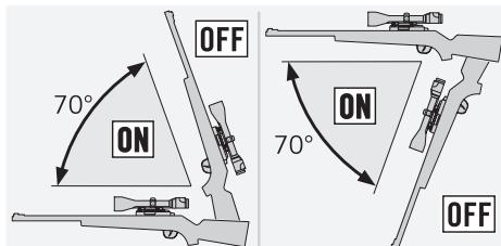
Il cannocchiale si spegne anche con un'inclinazione laterale di più di 30° come quando, ad esempio, poggiate l'arma sulle gambe.
