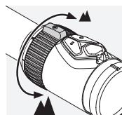
Draai de vergrotingsstelring tot maximaal 180° om de gewenste vergroting traploos in te stellen. De schaal op de stelring maakt een eenvoudig aflezen van de instelling mogelijk. Voor een betere oriëntering heeft de licht geprofileerde stelringomhulling een neusje. Afhankelijk van het model kan de vergrotingsstelring een vergrendeling hebben bij 1 maal vergroting (CLICKONE), waardoor u er opmerkzaam op gemaakt wordt dat u in het VIEWPLUS bereik gaat.
