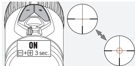
Kytke **FLEXCHANGE 4A-IF**-ristikon valaistu rengas käyttöön käänämällä POIS/PÄIVÄ/YÖ-kytkin PÄIVÄ- tai YÖ-asentoon. Ristikon valaistus on nyt aktivoituu. Kytke valaistu rengas käyttöön painamalla painikkeita +/- samaan aikaan kolmen sekunnin ajan. Kytke rengas pois käytöstä toistamalla tämä vaihe.
