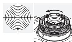
Ruotate l'anello zigrinato esterno sulla torretta superiore in direzione dell'H (senso antiorario).
