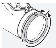
Käännä ensin silmäkohtaisen säätörengas täysin vasemmalle (vastapäivään) ja sitten oikealle, kunnes ristikko on täysin tarkentunut. Säätövara vaihtelee malleittain. Lisätietoja on tuotteen teknisissä tiedoissa.
