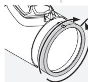
Drehen Sie erst den Dioptrienstellring ganz nach links (gegen den Uhrzeigersinn) und dann nach rechts, bis das Absehen die optimale Schärfe zeigt.
