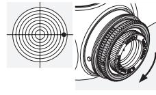
Tournez la bague moletée extérieure de la tourelle latérale dans le sens inverse de la flèche R (sens des aiguilles d'une montre).
