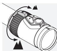
Haluttu suurennus saadaan käänämällä suurennuksen säätörengasta korkeintaan 180 astetta. Säätö on portaaton. Säätörenkaan asteikko helpottaa asetukseen hahmottamista. Karhennetussa ja pehmeässä säätökehässä oleva pieni ulkonema helpottaa käyttöä. Mallista riippuen on lukitus suurennussäätörenkaan avulla mahdollista 1-kertaiseen suurennokseen (CLICKONE), joka kiinnittiä huomiosi siihen, että siirryt VIEWPLUS-alueelle.
