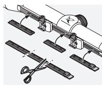
Det medföljande skyddet kan användas för att skydda skenans fritt liggande delar. Du kan skära till det i önskad storlek och trycka in det i skenan för hand.
