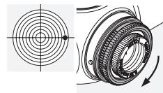
Vrid den yttre räflade ringen på sidotornet i motsatt riktning mot R (dvs. med-sols).
