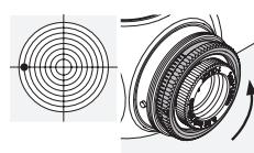
Поверните внешнее рифленое кольцо на боковой турели в направлении R (против часовой стрелки).
