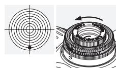
Drehen Sie den äußeren Rändelring der Höhenverstellung in Pfeilrichtung H+ - gegen den Uhrzeigersinn.
