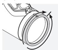
Сначала поверните кольцо диоптрической настройки влево (против часовой стрелки) до упора, а затем поворачивайте вправо, пока прицельная марка не будет в резком фокусе.
