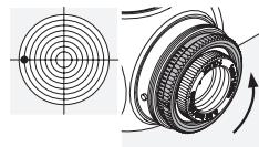
Vrid den yttre räflade ringen på sidotornet i pilriktningen R (dvs. mot-sols).
