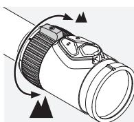
La anilla de ajuste de aumentos tiene un rango de giro de 180° para obtener el aumento deseado. El ajuste es continuo. La escala de la anilla de ajuste permite conocer en todo momento el nivel de aumento. La suave superficie ranurada de la anilla de ajuste tiene una pestaña que facilita identificar el punto de aumento en el que se encuentra. En función del modelo, la anilla de ajuste de aumentos incorpora una marca con 1x aumento (CLICKONE) para indicarle que está accediendo a la zona VIEWPLUS.
