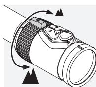
Genom att vrida förstoringsinställningsringen upp till 180° kan du ställa in önskad förstoring. Inställningen är steglös. Skalan på inställningsringen gör det enkelt att avläsa inställningen. Det mjuka, räfflade skyddet har en liten utskjutande del som gör det lättare att orientera sig. Beroende på modell har förstoringsinställningen en spärr vid 1x förstoring (CLICKONE) vilket gör dig uppmärksam på att du går in i VIEWPLUS-området.
