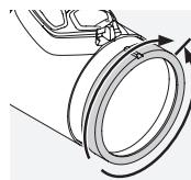
Drej først dioptriindstillingsringen helt til venstre (mod uret), og derefter til højre, indtil sigtet viser optimal skarphed. Indstillingsområdet afhænger af den individuelle model. Du kan finde flere oplysninger i det vedlagte tekniske dataark.
