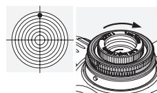
Drehen Sie den äußeren Rändelring der Höhenverstellung entgegen der Pfeilrichtung H- im Uhrzeigersinn.
