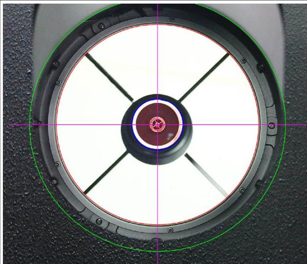
Die Kollimation des Fangspiegels ist abgeschlossen, wie in Abbildung 6 dargestellt.
