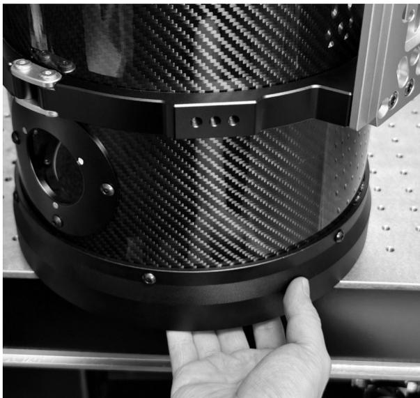
Abbildung 3: Halten Sie die Spiegelhalterung mit der Hand fest und drehen Sie das gesamte Teleskop um 180 Grad, sodass der Tubus auf dem Kopf steht.
