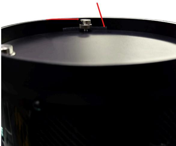
Abbildung 6: Die endgültige Position der Spiegelbefestigungsschrauben sollte unterhalb der Kante der Spiegelbasis liegen, sodass die drei freiliegenden Gummi-Begrenzungsstreifen deutlich sichtbar sind.
