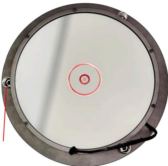
Abbildung 1: Legen Sie die Halterung für den Hauptspiegel auf eine ebene Fläche. Verlegen Sie das Stromkabel für die Heizung des Hauptspiegels über die Oberseite des Spiegels und achten Sie darauf, dass es innerhalb der Halterung bleibt. Setzen Sie drei Federn in die dafür vorgesehenen Aussparungen ein.
